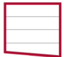
Pavimenti in pendenza dove si interviene con il taglio inclinato del pannello di base e il montaggio di una guarnizione speciale. Sloped floor - in such a case, the door features a bevel-cut, special-gasket, bottom panel.
