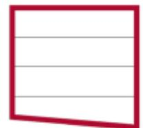
Pavimenti in pendenza dove si interviene con il taglio inclinato del pannello di base e il montaggio di una guarnizione speciale.
